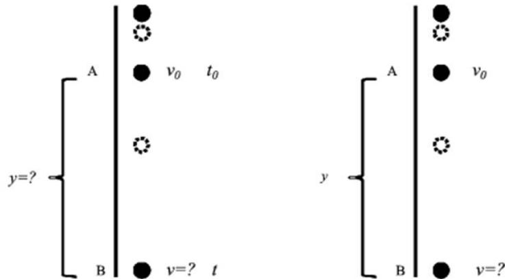
Figura 4.4: Caída libre: **a)** Velocidad final y distancia recorrida en función de la velocidad inicial y el tiempo. **b)** Velocidad final en función de la distancia recorrida y de la velocidad inicial.
